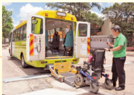
自動輪椅升降台 Automatic wheelchair lift
