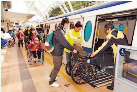
手攜式摺板 Portable Ramp
